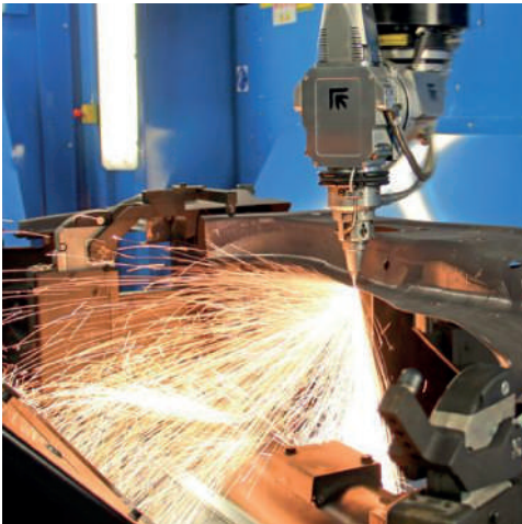
Una macchina da taglio laser moderna di Prima Industrie: particolare della testa di taglio.
