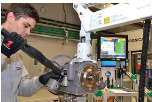
Successivamente è stato integrato un sistema di stazioni di chiavi per la chiusura a coppia controllata che, in connessione Wi-Fi con la
