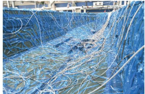
Per stabilizzare e rendere ancora migliori le caratteristiche meccaniche dello scafo si ricorre poi ad una cottura in forno a bassa temperatura(60°C), una volta ottenuto lo scafo, appunto aperto, si cala il cosiddetto vassoio, ponte inferiore, con eventuale preallestimento a terra per poi far seguire la calzatura della coperta, anch'essa sempre di più allestita a terra negli ultimi tempi.
