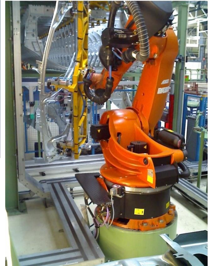
Robot con gripper di manipolazione
