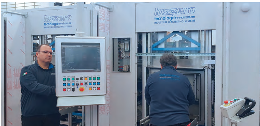
Tecnici Lazzero al lavoro in una fase di montaggio di una macchina di collaudo
