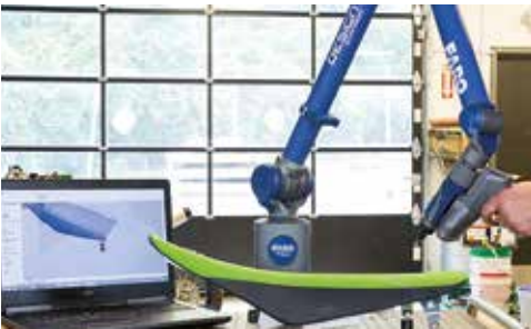
Braccetto antropomorfo con digitalizzatore a contatto e pistola rilievo laser con software Metrolog
