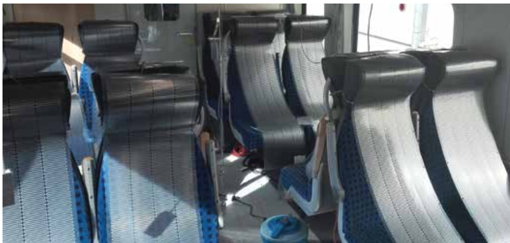
Test sperimentali di valutazione parametri clima-comfort su carrozza ferroviaria
